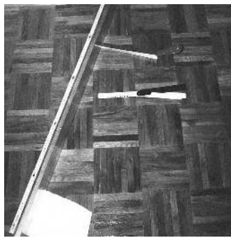
Abb. 9: Praktische Messungen der Ebenheit eines Fußbodens mit Richtschiebe, Zollstock und Messkeil
